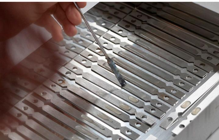
Mit Bioindikatoren wird die Funktionsfähigkeit von Reinigungs- und Desinfektionsgeräten in medizinischen Einrichtungen überprüft. Die Edelstahlstreifen werden dazu vorher künstlich verschmutzt. © LUA
