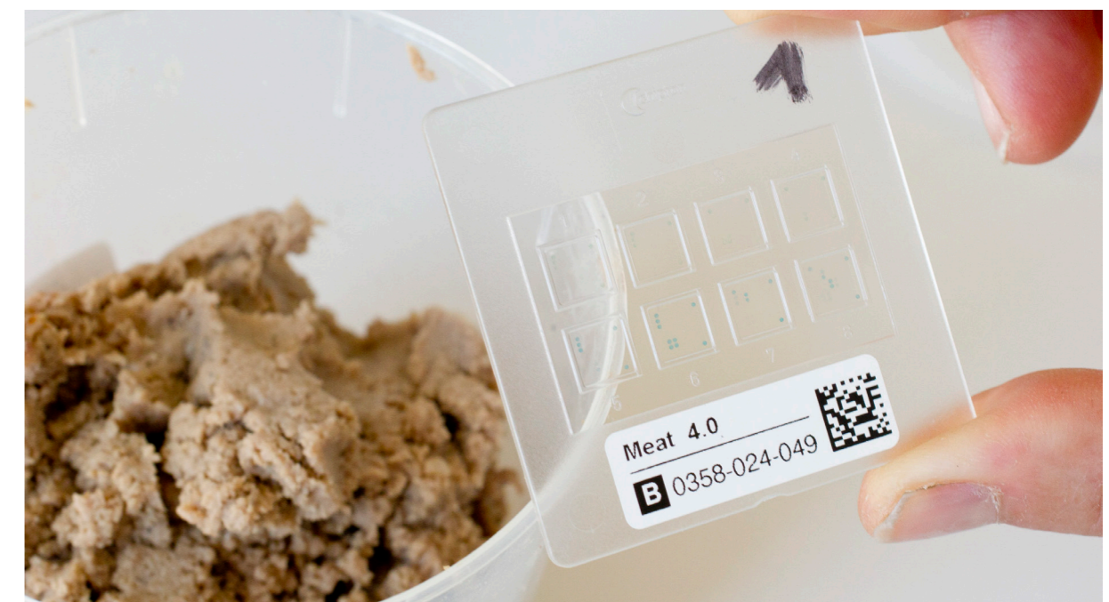
Panschern auf der Spur: Mit einer modernen Methode können Fleischgerichte auf einen Schlag auf 24 verschiedene Tierarten untersucht werden. Selbst exotische Sorten wie Pfau oder Kamel erkennt der Chip. (Foto: LUA)
