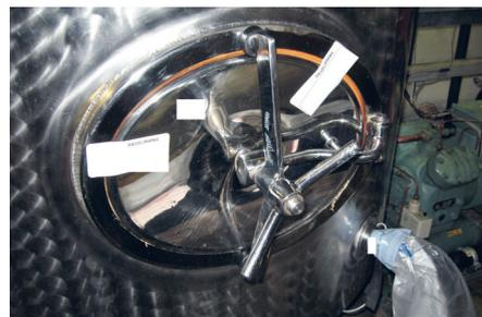
Ein Doppelmantel-Tank war direkt mit einem Kühlkompressor verbunden, quasi eine riesige Gefriertruhe.
